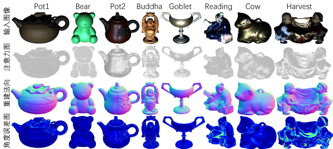
图 3-7 DiLiGenT 数据集中 [31] 不同物体通过提出的自适应注意力光度立体模型预测的注意力图、重建的表面法向和对应的角度误差图
